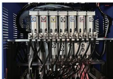
Yüksek hızlı baskı koşullarında istikrarlı mürekkep beslemesi sağlamak için uluslararası genel mürekkep besleme sistemi benimsenmiştir
