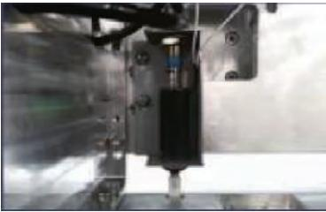
Malzeme otomatik yükseklik ölçüm sistemi 35mm yükseklikte malzeme baskısını karşılayabilir
